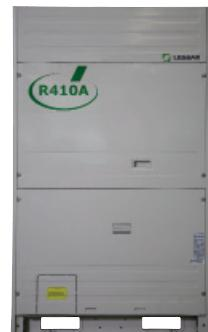
**LMV-Increase** – наружные блоки производительностью 28, 33.5 и 45 кВт, причем суммарная мощность может наращиваться до 180 кВт путем объединения модулей различной производительности в одну систему с возможностью подключения до 64 внутренних блоков.
