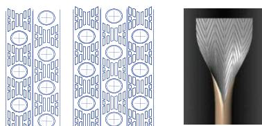
Внутренняя винтовая насечка медных труб и конфигурация теплообменника повышают его эффективность на 10% и увеличивают площадь теплообмена на 30%.
