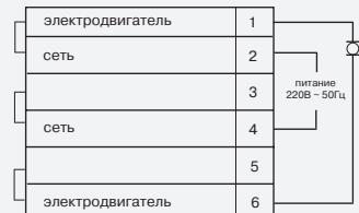
Контакты 1-2, 3-4, 5-6 соединены попарно. Для включения электродвигателя на максимальную мощность поставить перемычку между контактами 3 и 5. Датчик температуры не имеет полярности.
