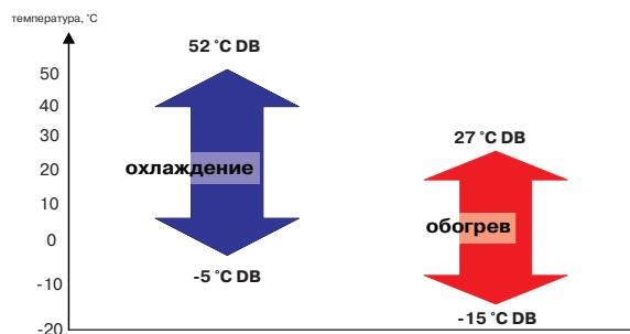
Мультизональные системы **LESSAR LMV - Increase** обладают еще более широким диапазоном рабочих температур наружного воздуха, что обеспечивает надежность работы в более жестких климатических условиях.
