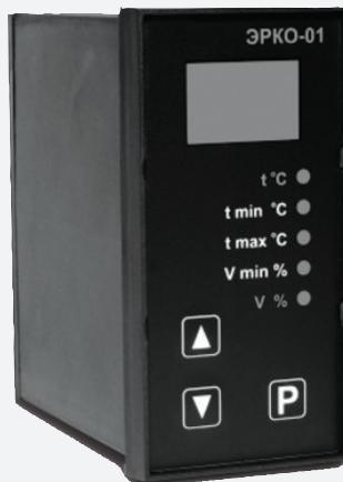
Блоки управления вентилятором для систем кондиционирования воздуха ЭРКО-01 и ЭРКО-02 предназначены для регулировки скорости вращения вентилятора в зависимости от температуры, измеряемой внешним датчиком. Приборы применяются для поддержания необходимого давления в кондиционерах, что позволяет им работать в режиме охлаждения при температуре наружного воздуха до -25 °C (см. стр. 18-19).
