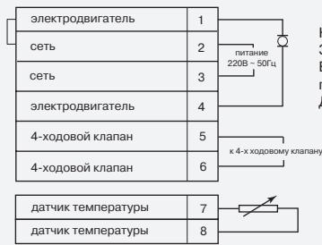
Небольшие габариты. Защита от выхода из строя вентилятора. Встроенное реле работы в режиме обогрева. Датчик температуры не имеет полярности.
