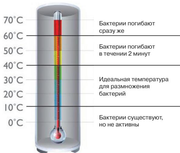
Для борьбы с бактериями использование одного лишь хлорирования в системах горячего водоснабжения недостаточно, так как существуют бактерии довольно устойчивые к хлору. Именно поэтому в аккумуляторных баках систем LESSAR Heat Pump введена функция автоматического уничтожения бактерий посредством их термической обработки.
